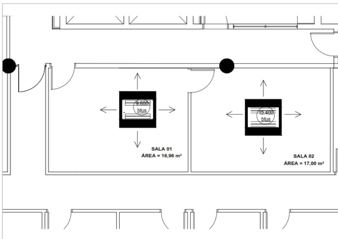
Planta Baixa da locação dos equipamentos de Ar-Condicionado
